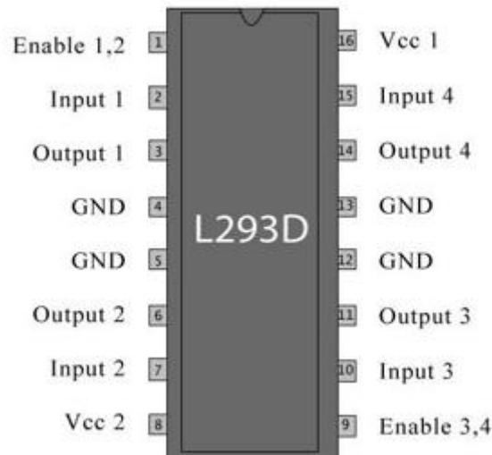
**Figure 5 IC L293D Pin-out Diagram**
